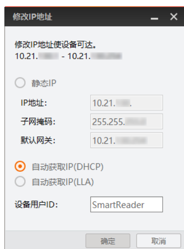
图 10-6 修改单个读码器 IP 地址
