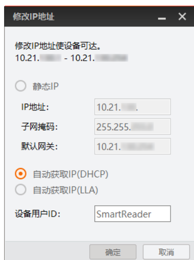
图 10-6 修改单个读码器 IP 地址
