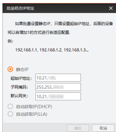
图 10-7 同时修改多个读码器 IP 地址
