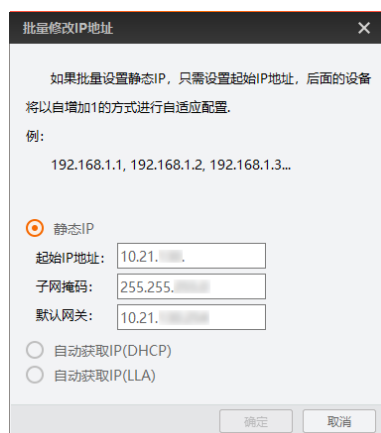
图 11-7 同时修改多个读码器 IP 地址
