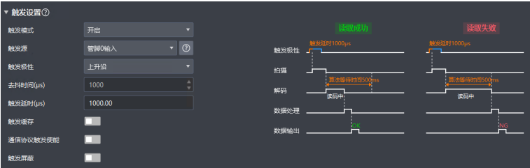
图 8-16 管脚 0 输入触发时序图示例
